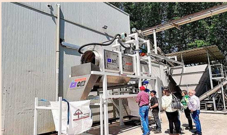
Mainer ha construido una máquina que separa la membrana de la cáscara y la deja limpia.
